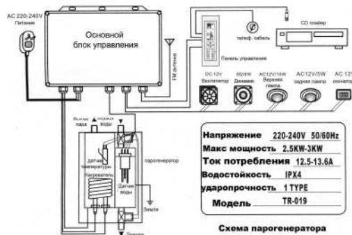
Схема парогенератора
